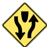
Начало автомагистрали (дороги) с разделительным бордюром
