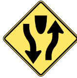
Начало автомагистрали (дороги) с разделительным бордюром
